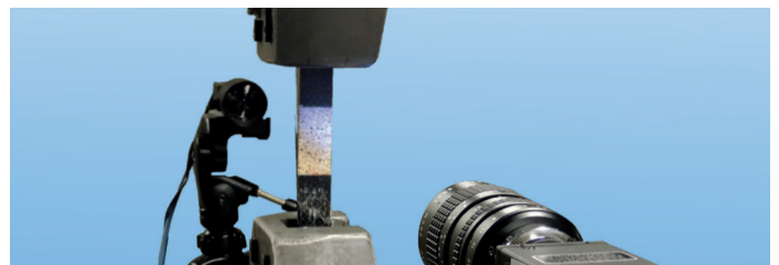
1 Zugversuch mit optischer Dehnungsmessung.
