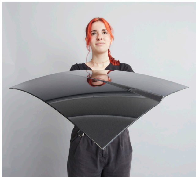
Komplex geformtes Glas mit nach hinten auslaufendem Knick.
