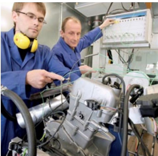
1 Einzylinderforschungsmotor zur Messung von Reibung und Verschleiß.
