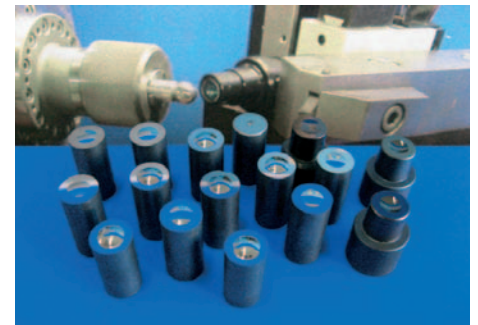
Abb. 1 Duktil bearbeitete Silicium-Werkzeuge mit optisch funktionalen Oberflächen für die Heißumformung von Glas.
