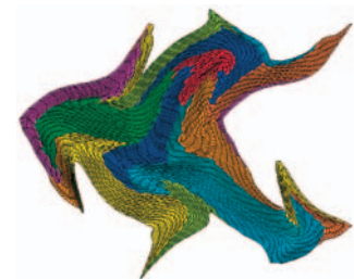
Abb. 2 Grain curling in einem Wolframdraht a) im Querschliff beobachtete Kornstruktur, b) mit einem Einkristallplastizitätsmodell simuliert
