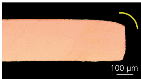
Abb. 3 Einseitige Kantenverrundung an Elektroden von Hochspannungs-Vakuumbauteilen; keine optimierten Elektropolierparameter.
