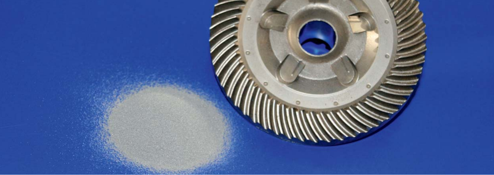
Sinterstahlpulver und daraus durch Pressen hergestelltes Tellerrad.
