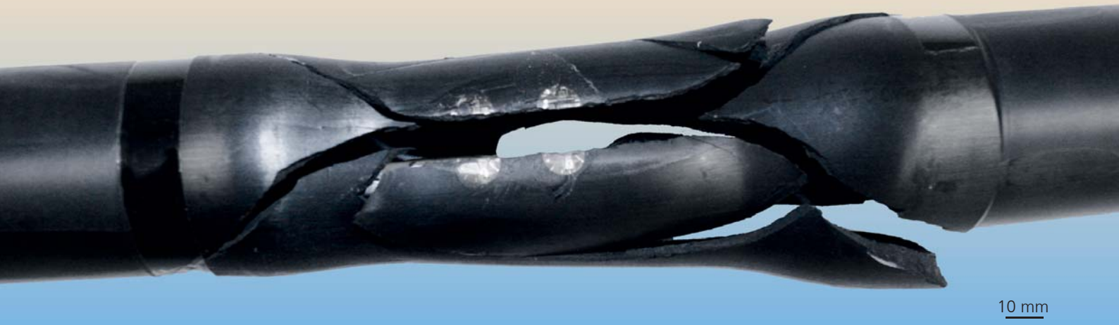
GFK-Rohrprobe nach Berstversuch.
