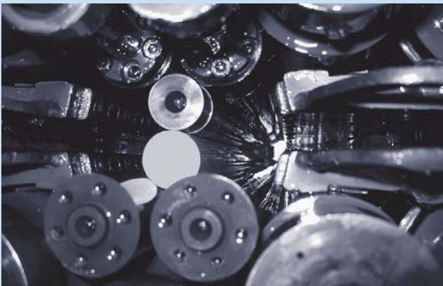
1 Keramische Folienwalze im Walzgerüst bei MK-Metallfolien GmbH. Foto: © Universität Duisburg-Essen.
