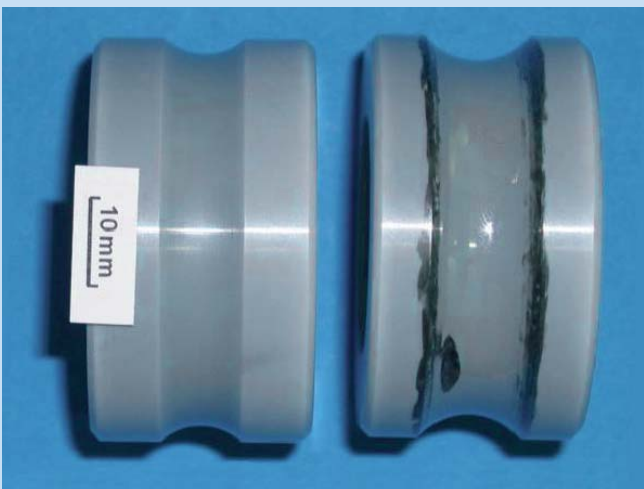
2 Drahtführungsrollen vor und nach Erprobung im Walzwerk bei Böhler Edelstahl GmbH & Co. KG. Die Einglätung der Keramikoberfläche ermöglicht eine sehr gute Oberflächenqualität und eine bis 10-fach höhere Lebensdauer der Führungsrollen. Links: neue Rolle. Rechts: im Walzwerk erprobt.
