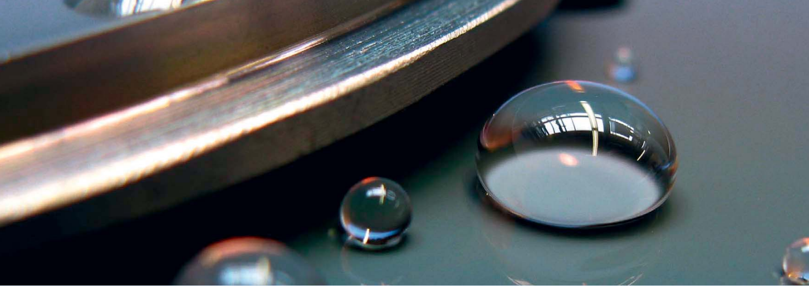
Ultrahydrophobe Hybridschicht mit stark wasser- und medienabweisenden Eigenschaften zur trennmittelfreien Entformung von Polyurethan.
