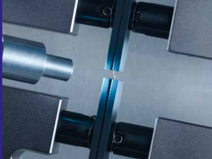
Belastungstest an Solarzellen-Verbindungen mit Mikrotester.
