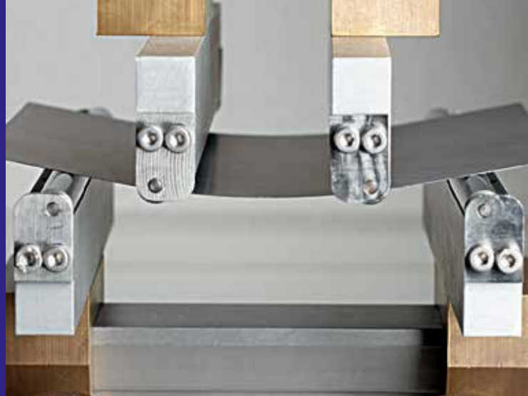
Durchbiegung eines multikristallinen Silizium-Wafers während des 4-Punkt-Biege-Versuchs.
