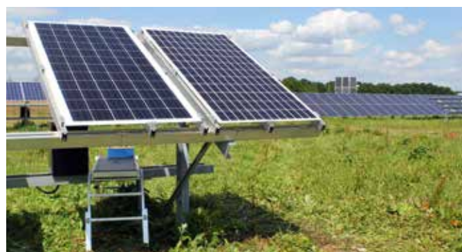
2 Voll- (links) und Halbzell- (rechts) Module im Freifeldtest (1,10 x 2,00 m).
