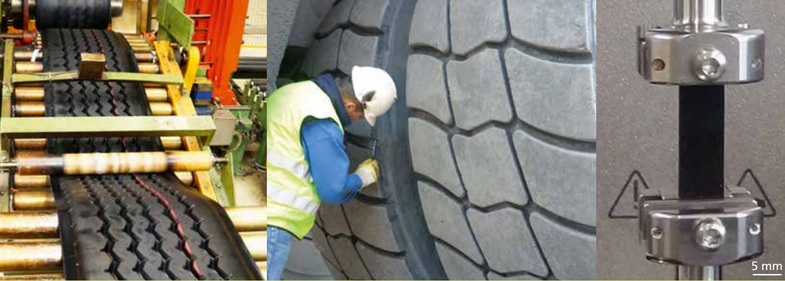
Laufstreifenherstellung (links) (Marangoni GmbH) und Prüfung von runderneuertem EM-Reifen (Mitte und rechts).
