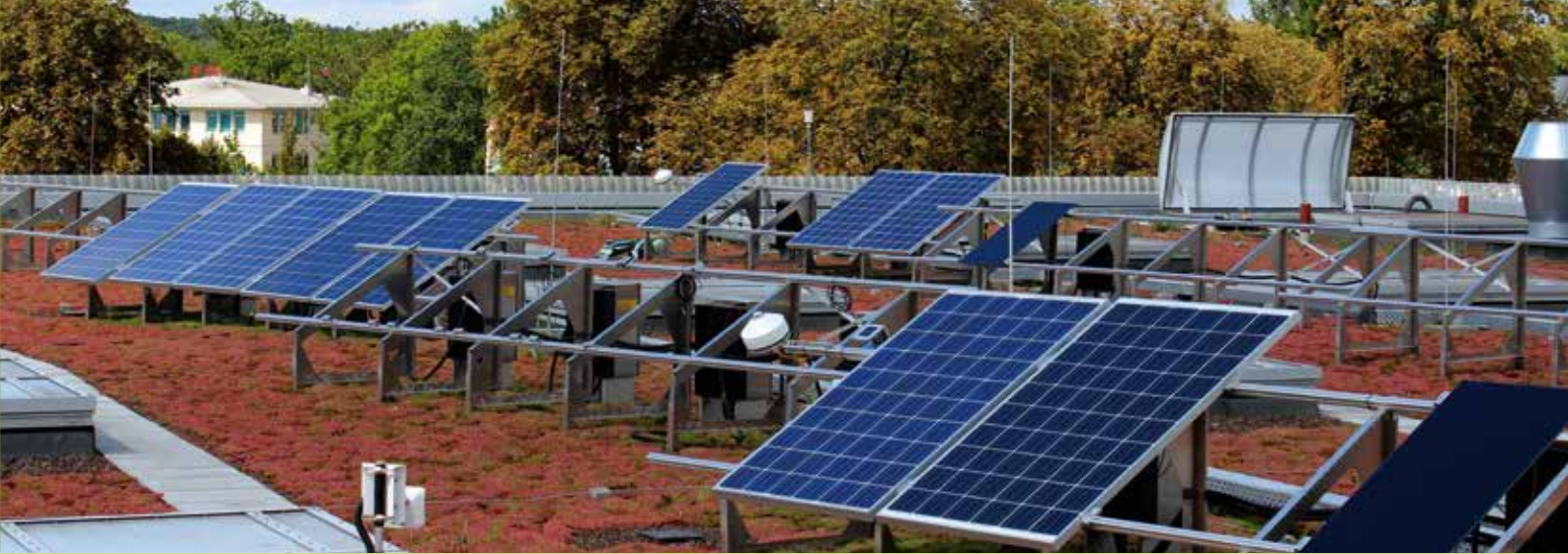
Freifeld für Photovoltaikmodule zur Ertragsmessung auf dem Dach des Fraunhofer CSP.
