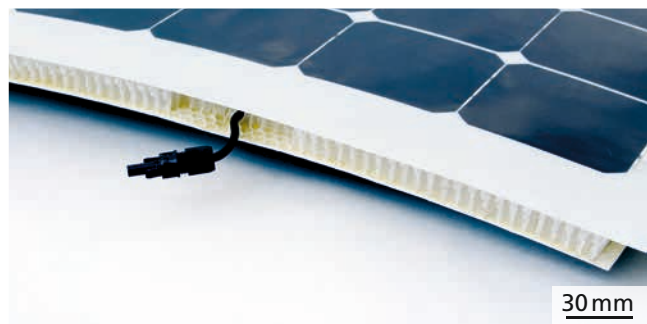
1 Gewölbtes Leichtbaumodul auf Basis von faserverstärkten Kunststoffen mit thermoplastischem Wabenkern.
