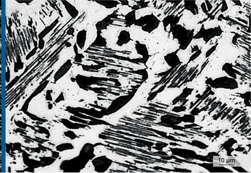
3 REM-Aufnahmen der Legierung TNM-B1 nach Wärmebehandlungen: vollständig lamellares Gefüge (links); Duplex-Gefüge (rechts).
